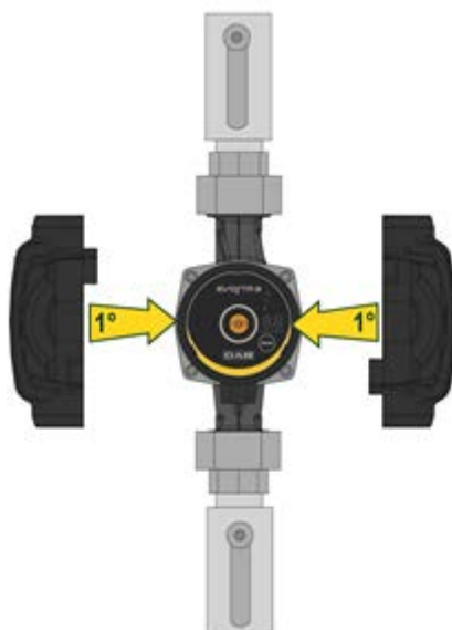
Figura 6: Aislamiento del cuerpo de la bomba
